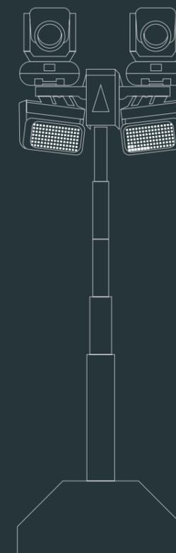
Die **P3 Event Lichtmasten** verfügen über eine eigene Stromversorgung, zwei Hochleistungs-Moving-Heads und zwei lichtstarke RGB-Fluter und werden über W-DMX gesteuert.
