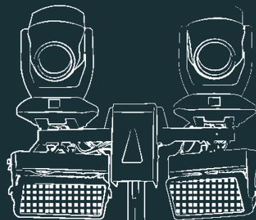
Die **P3 Event Lichtmasten** verfügen über eine eigene Stromversorgung, zwei Hochleistungs-Moving-Heads und zwei lichtstarke RGB-Fluter und werden über W-DMX gesteuert.
